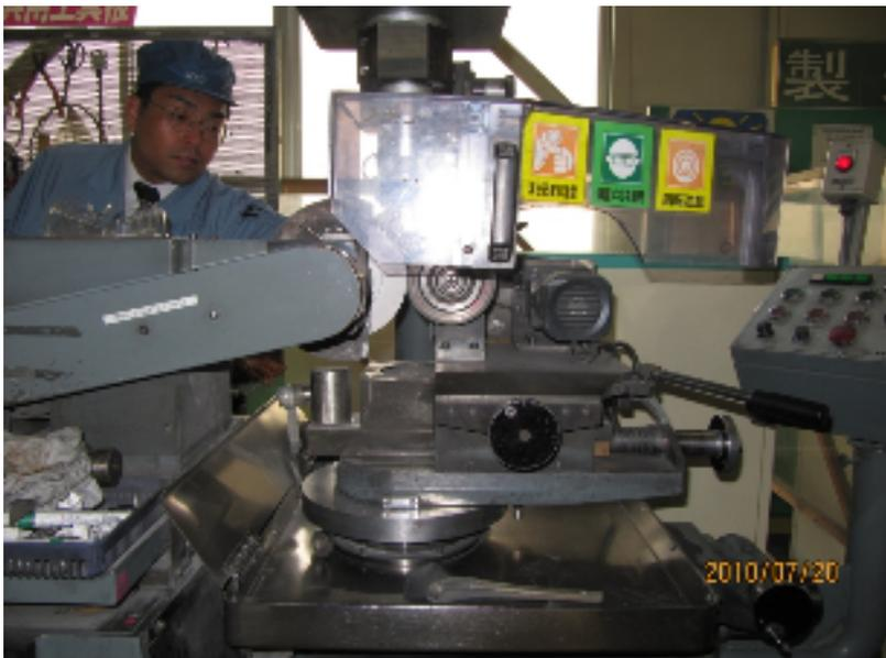
写真 1 超硬合金研磨作業
